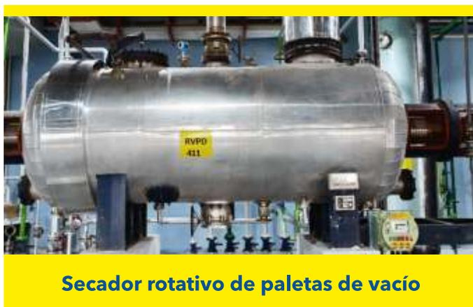
**Secador rotativo de paletas de vacío**
